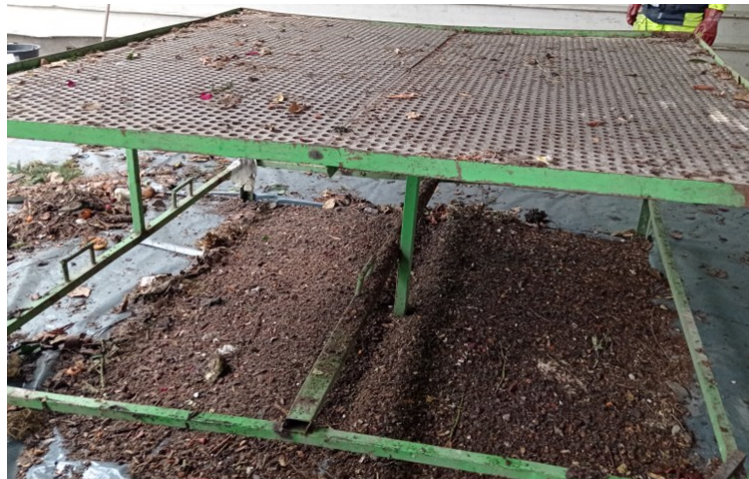
Slika 5.4.3: Ostanek po prebiranju (presevek skozi sito premera 20 mm) iz vzorca BIOO z opazovanega območja v občini Selnica ob Dravi
