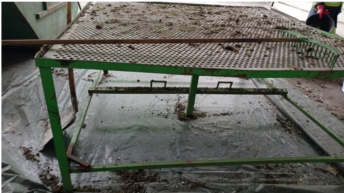
Slika 4.3.3: Perforirano sito z okroglimi odprtinami premera 20 mm za sejanje odpadkov
