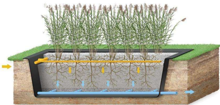
Shema delovanja rastlinske čistilne naprave z vertikalnim tokom (arhiv Limnos).
